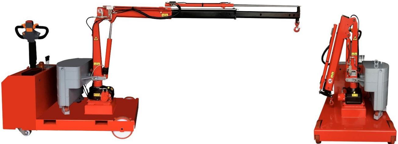
ORBIT 200EL und ORBIT 200ER sind vollelektrische Pick & Carry-Schwenkkrane mit einer Traglast von 200 kg. Eines der Hauptmerkmale dieser Pick & Carry Kranen ist, dass keine seitlichen Abstützungen erforderlich sind und sind mit der Last verfahrbar.
